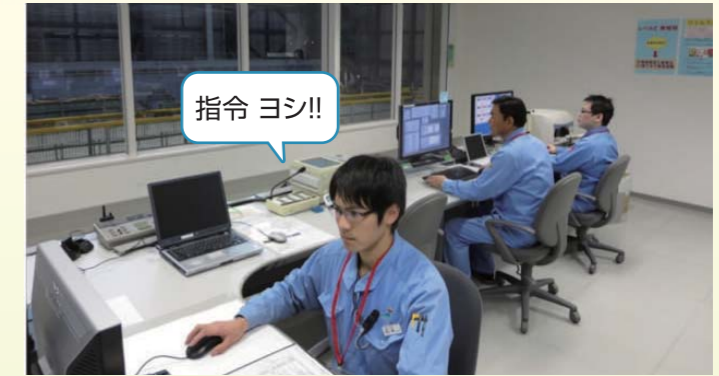
加振制御装置により、作動油の流量監視などを行なうと同時に、震動台へ指令を出し、震動台を変位させます。
