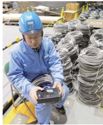
計測ケーブルの点検
